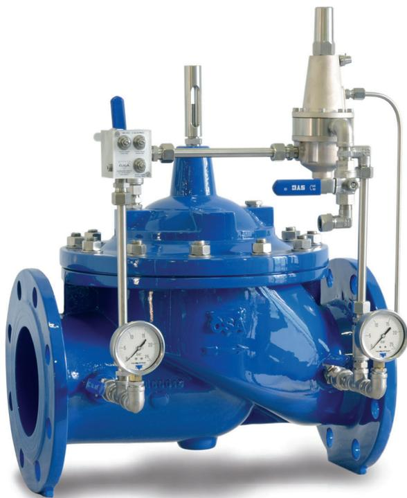
La valvola automatica a funzionamento idraulico CSA XLC 395/495 sostiene la pressione di monte in modo differenziale, fra due valori regolabili, indipendentemente dalle variazioni della portata.
