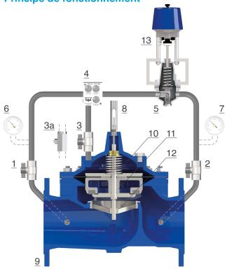
La vanne de régulation modèle XLC 310/410 est une vanne automatique commandée par un pilote (5) à 2 voies à consigne réglable.
