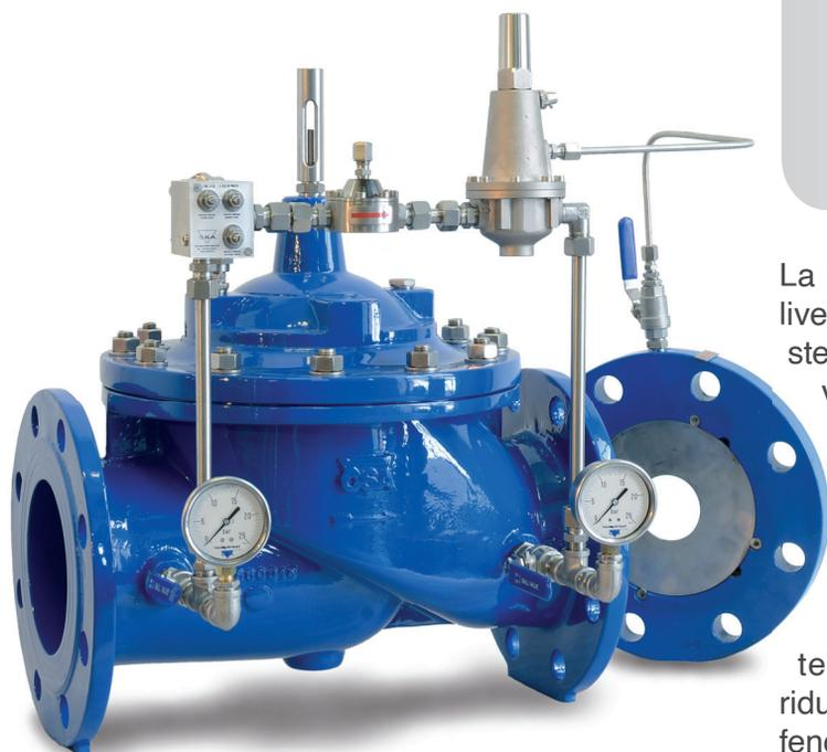
La valvola automatica CSA XLC 334/434 regola il livello minimo e massimo di un serbatoio, e nello stesso tempo mantiene la portata al di sotto di un valore massimo. Il circuito prevede un orificio flangiato, che dev'essere collegato al pilota ed è necessario al suo funzionamento.
