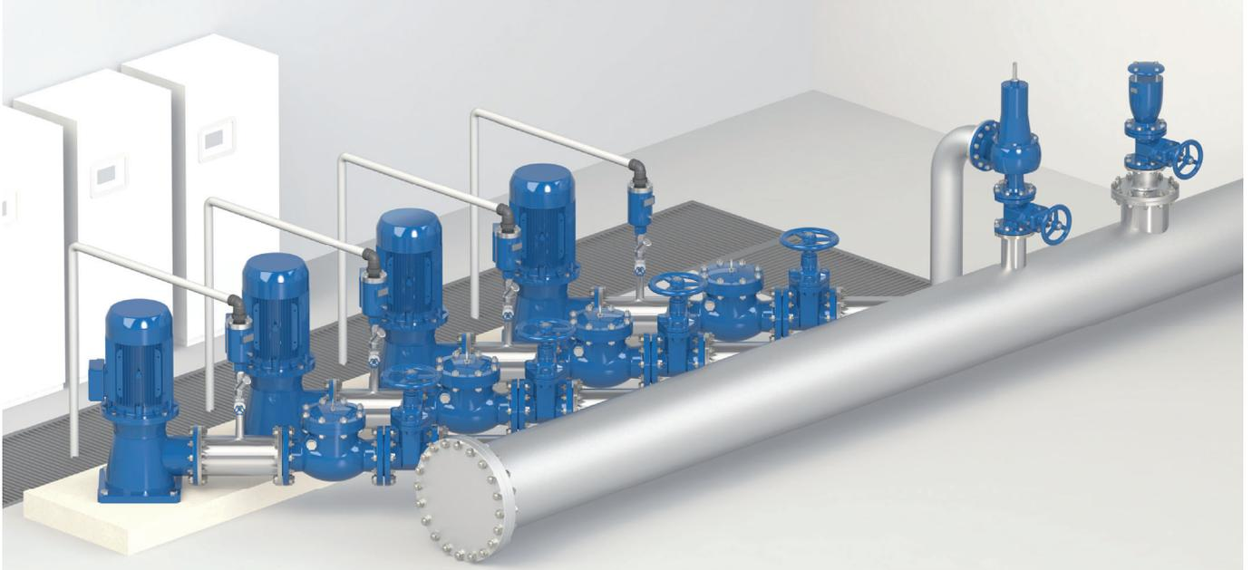
**Installation de vanne de régulation:** Dans ce deuxième schéma, la soupape Gemina est installée en aval d'un poste de vanne de réduction de pression pour éviter dans tous les cas une montée en pression sur la ligne principale. L'installation comprend également un réducteur de pression CSA XLC 310/410, un by-pass pour la maintenance et des ventouses FOX ou LYNX 3F AS en amont et en aval.
