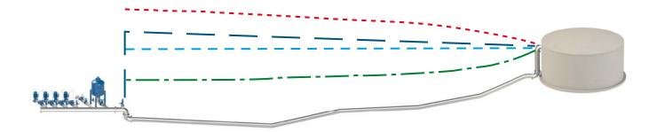
Le graphique ci-dessus montre l'évolution des pressions lors d'un phénomène transitoire causé par une panne de pompe sur un réseau avec un réservoir SPT. installé en protection. Les courbes rouge et verte sont les valeurs de pression maximale et minimale atteintes lors de la simulation. On voit bien l'effet bénéfique du réservoir SPT en termes de dépression et par conséquent de réduction des coups de bélier.
