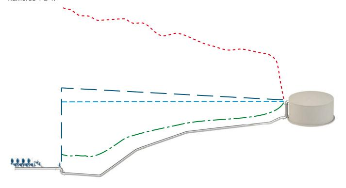
Les effets de l'arrêt de la pompe peuvent être visualisés sur les graphiques de l'évolution des valeurs de pression maximale et minimale obtenues lors de la simulation (dans l'illustration représentée, respectivement, en rouge et en vert). On note comment le système atteint le « vide absolu » sur une grande partie du profil, et le coup de bélier provoqué par le décollement de la veine au changement de pente.
