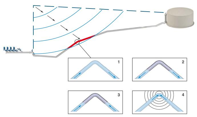
Le diagramme ci dessus montre la propagation de l'onde de pression négative le long de la canalisation aval. La partie de la conduite exposée à une forte pression négative est ombrée en rouge. Le changement de pente est un point où un décollement de veine peut se produire, lorsque des poches de vapeur se forment puis éclatent, générant de dangereux coups de bélier, comme illustré dans les photos numéros 1 à 4.
