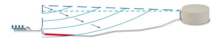
Le diagramme ci-dessus montre le profil d'une canalisation, avec des pompes et un réservoir en aval les conditions limites d'utilisation. La ligne pointillée bleu foncé représente le HGL et la ligne pointillée bleu clair la pression statique. L'onde de dépression qui se propage en aval du fait de l'arrêt de la pompe est mise en évidence. Le segment rouge correspond au tronçon touché par la dépression lors de la phase initiale de l'événement.
