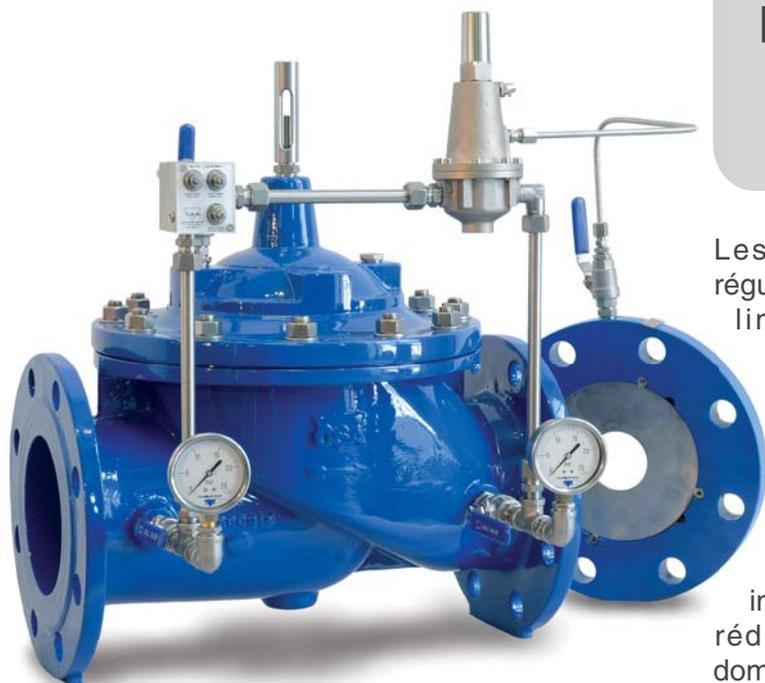
Les vannes XLC 430 sont des vannes de régulation à fonctionnement 100% hydraulique qui limite le débit à une valeur constant indépendamment des de la variation de la pression amont. En cas de débit inférieur à la valeur de réglage, la vanne s'ouvre complètement.
